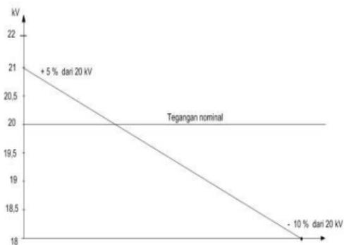
15 Gambar 2.8 Toleransi Tegangan Yang Di izinkan
